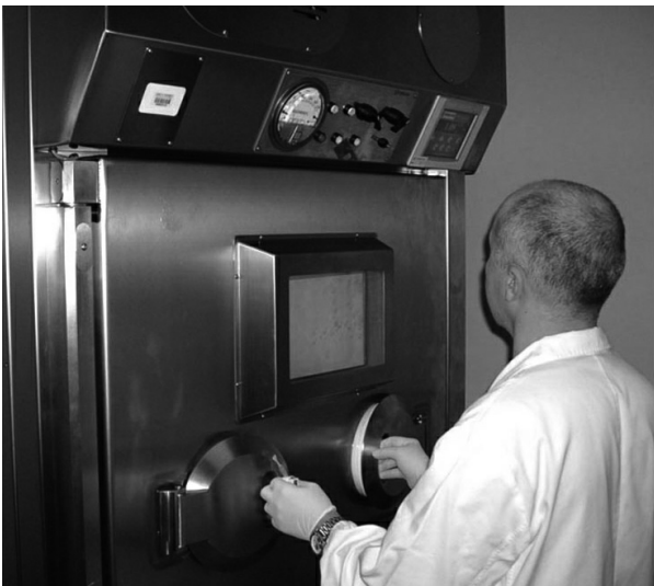
Figura 3. Cella calda (modello Manuela Beta della Comecer) per la manipolazione dei prodotti radioattivi.
